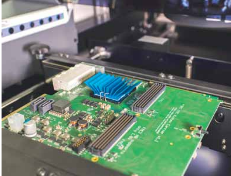
Uniwersalny moduł AMC z układem programowalnym FPGA serii Kintex i interfejsami rozszerzeń FMC
