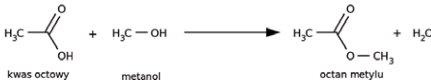
Rys. 1A. Reakcja powstawania estru – octanu metylu \text{CH}_3\text{COOCH}_3 , z kwasu octowego \text{CH}_3\text{COOH} i alkoholu metylowego \text{CH}_3\text{OH}
