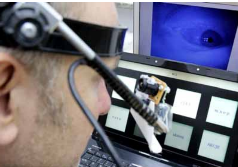
Rys. 6. Pierwszy prototyp okulografu wykonanego na UW z użyciem kamery od konsoli PS3 i oprogramowania OpenBCI.
